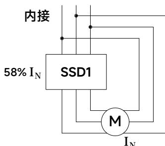
软起动器主回路有内接、外接两种方式
