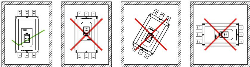
2、软起动器运行时要产生热量，为确保冷却空气的通路，如下图安装要求所示，软起动器周围应留有一定的空间，此为最小安装允许间距，因产生的热量向上散发，所以请不要安装在不耐热设备的下方。
