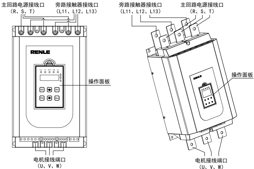
M1 主回路接线端口示意图
